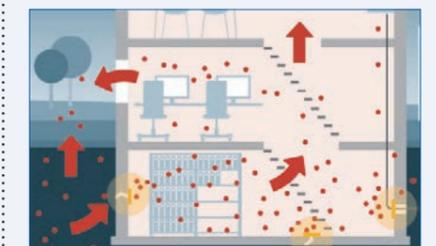
Um Radon den Eintritt ins Gebäude zu erschweren, sollten alle undichten Stellen wie Risse oder Fugen im Gebäudebereich mit Erdkontakt abgedichtet werden.
