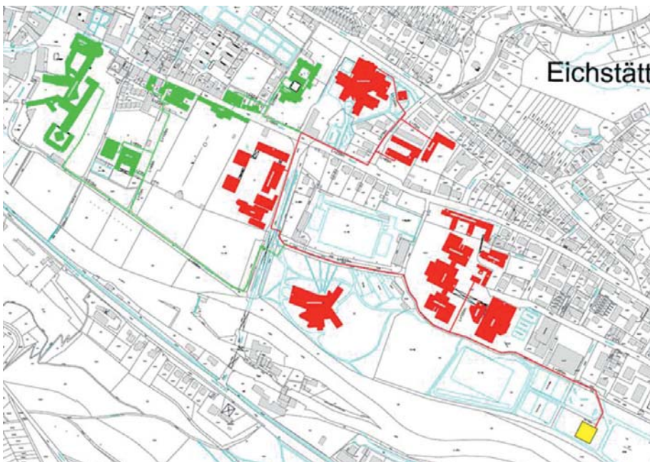
Abbildung 1: Straßenzugsweiser Wärmekataster mit hohen Wärmebelegungsdichten im Osten (rot) sowie im Westen (grün) der Stadt Eichstätt
